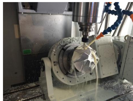
Рис 14. Крыльчатка, установленная на столе станка серии 61BM
