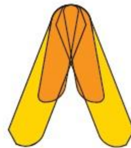
Рис. 3. Деление припуска на обработку путем тангенсального расположения режущих пластин в корпусе инструмента
