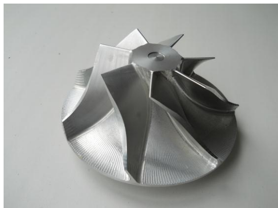
Рис 15. Внешний вид геометрии крыльчатки турбины для отработки пятиосевых траекторий в программе SPRUT
